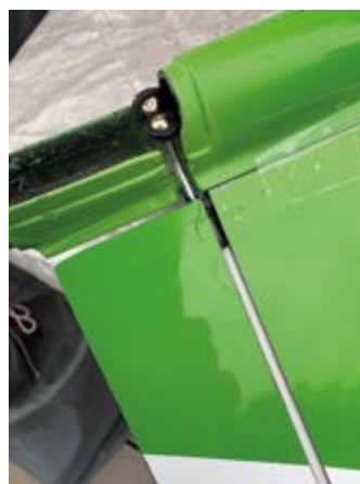
Eine heikle Arbeit ist der Einbau der HL/SL Anlenkungen
