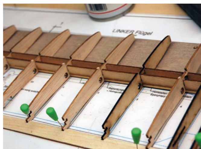
Durch die Hilfsleiste ist der Aufbau der Tragflächen präzise und leicht möglich
