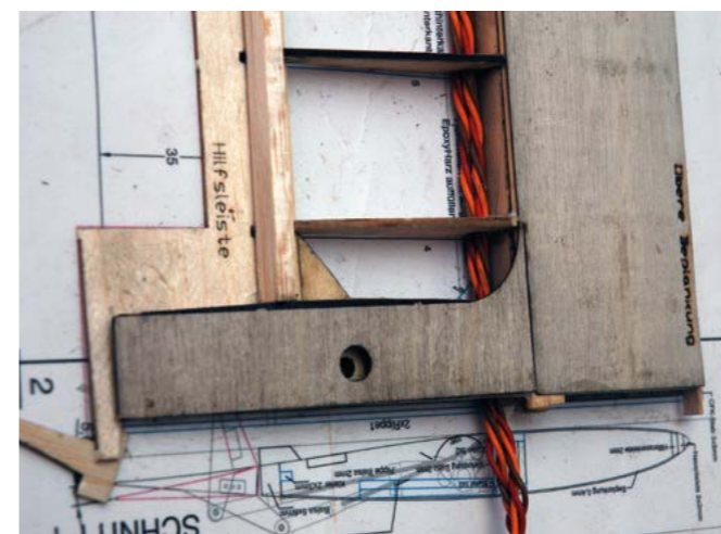
Aufbringen der oberen Beplankung und Führung der Servokabel
