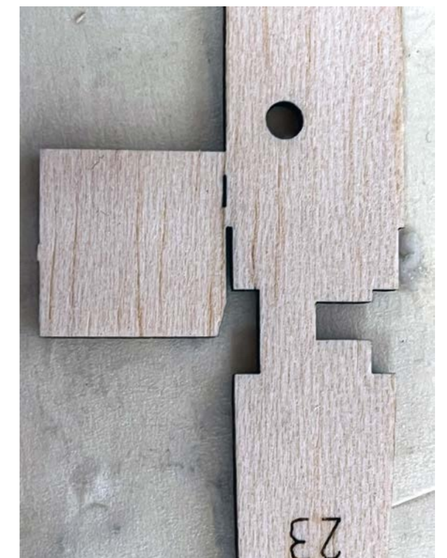
Aufbau der Flächen auf der Helling – hier ist Vorsicht geboten, denn die Stege brechen leicht.
