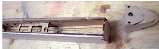
Die Rumpfspitze kann man noch vor dem Aufkleben vorsichtig beschleifen.
