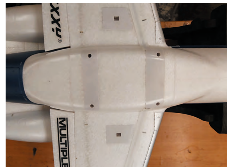
Die einteilige Tragfläche wird mit vier Schrauben M3x16 mm mit dem Rumpf verbunden.
