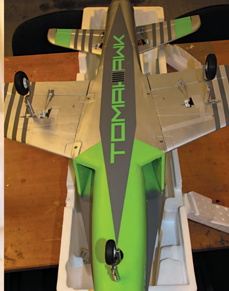
Das starre Hauptfahrwerk ist vorbildgetreu ausgeführt und wird in die dafür vorgesehenen Laschen fixiert.
