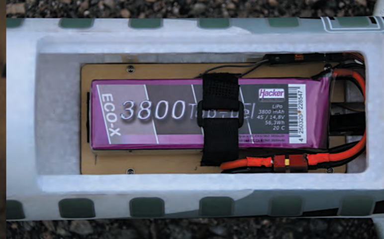
Ausreichend Raum für den Vierkanal-Empfänger und den 4s, 3.800 mAh Flugakku befindet sich unter dem am Rumpfrücken angeordneten Deckel.
