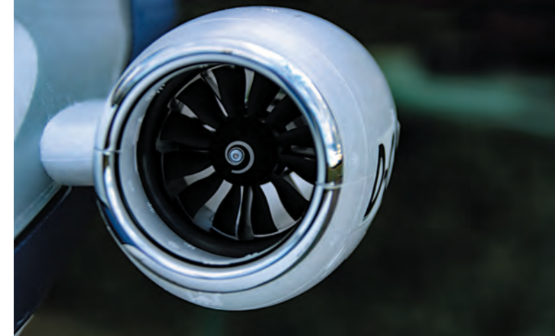
Für kräftigen Schub sorgen zwei zwölfblättrigen Impeller mit einem Durchmesser von 50 mm. Sie befinden sich in Triebwerks gondeln am Heck des Learjets.
