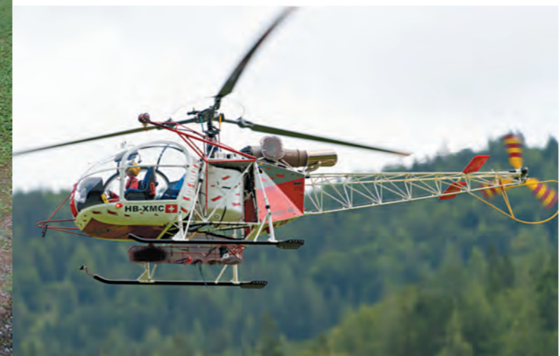
Pilot STEFAN WEIHRER vom MFC Kössen präsentierte seine Lama Sa315b (kompletter Eigenbau) mit einem Rotordurchmesser von 2.800 mm, angetrieben von einer Pahl Turbine. Das Abfluggewicht beträgt 22.000 Gramm, der Heli ist ein Eigenbau im Maßstab 1/4, die Rotorblätter stammen von Mblades.
