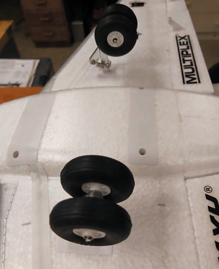
Das robuste und gefederte CNC-Metall-Hauptfahrwerk macht einen soliden Eindruck, ist aber nicht einziehbar.
