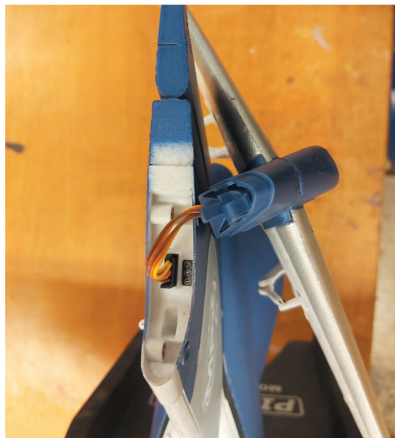
Am oberen Ende des Seitenleitwerks wird das Höhenleitwerk mit einer 3x12 und 3x16 mm Schraube befestigt. Jedoch muss man vorher noch das dreipolige Servokabel zur Ansteuerung des Höhenruders miteinander verbinden.
