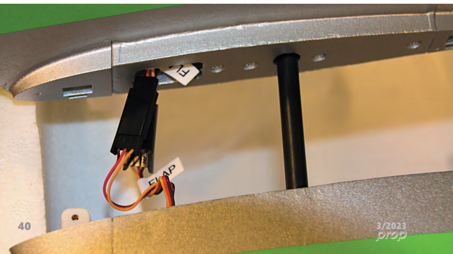
Die Tragflächenhälfte wird auf den CFK-Flächenverbindungsstab aufgeschoben und mittels M3x10 mm Schrauben gesichert. Vorab muss man, so wie beim Seitenleitwerk auch die beiden Servokabel für das Querruder und Landklappe miteinander verbinden.
