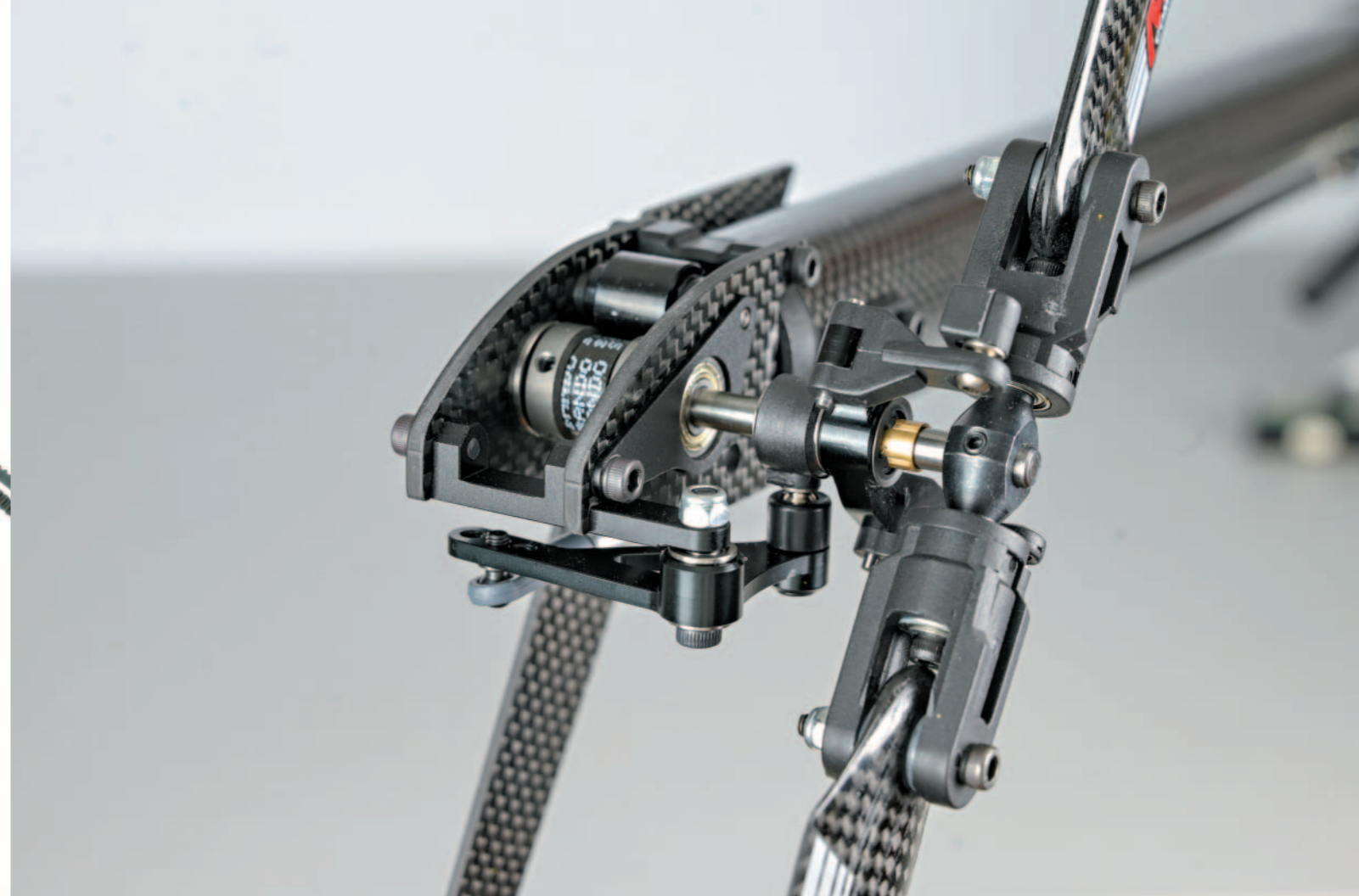
Das Heck kommt mit minimalen Komponenten aus. Der Heckrotor kann auch auf Wunsch links montiert werden, standardmäßig ist er in der Auslieferung rechts montiert.
