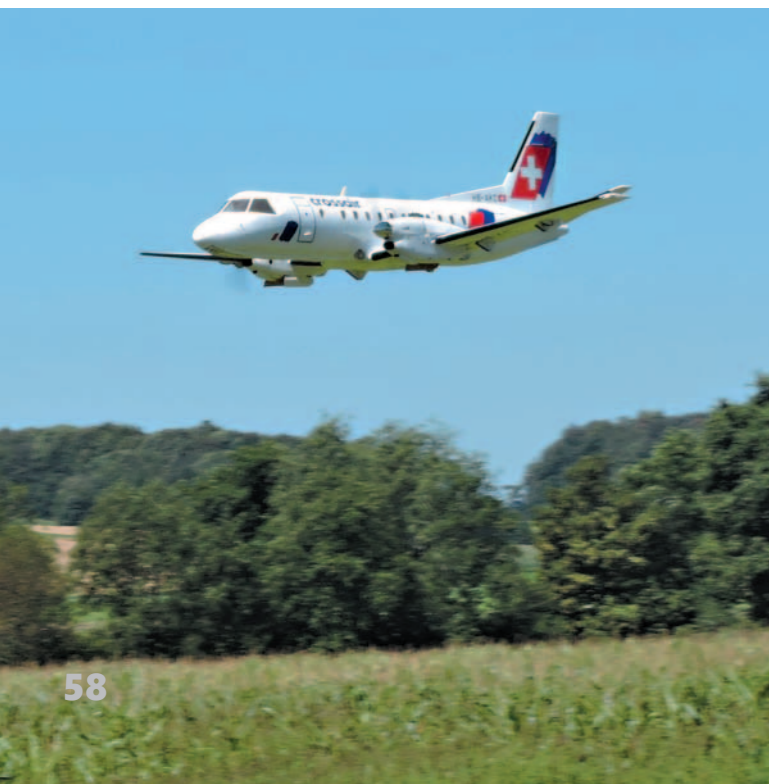
Die Crossair Saab 340B beim tiefen Überflug. Spannweite 3.600 mm, Gew. 22.000 g, Akku 2 x 12s, 6 Ah.
