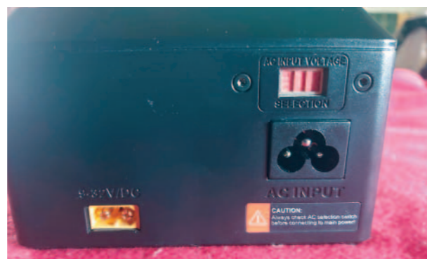
Betrieben wird das Ladegerät über die Steckdose mit 240 V AC, bzw. kann man über einen Spannungsschalter auch 110 V einstellen. Alternativ kann das Gerät auch mittels Gleichspannung (DC) von 9-32 Volt.
