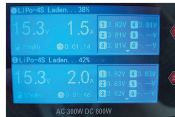
Das Display ist horizontal in zwei Bereiche für den rechten und linken Ladeausgang unterteilt. Beim Ladevorgang ist am Display die Akkuspannung/-strom, der Akkutyp, die Kapazität, Ladezustand sowie die Spannungen der einzelnen Zellen angezeigt. Zusätzlich ist noch die zum Laden benötigte Zeit ersichtlich.
