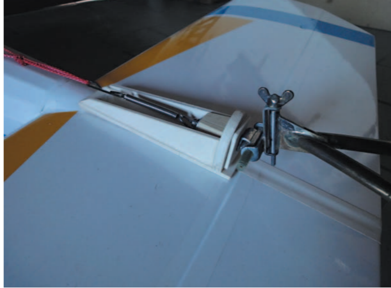
Am Höhenleitwerk befindet sich als Verbindung zwischen Schleppmaschine und Gespann ein Kardangelen.
