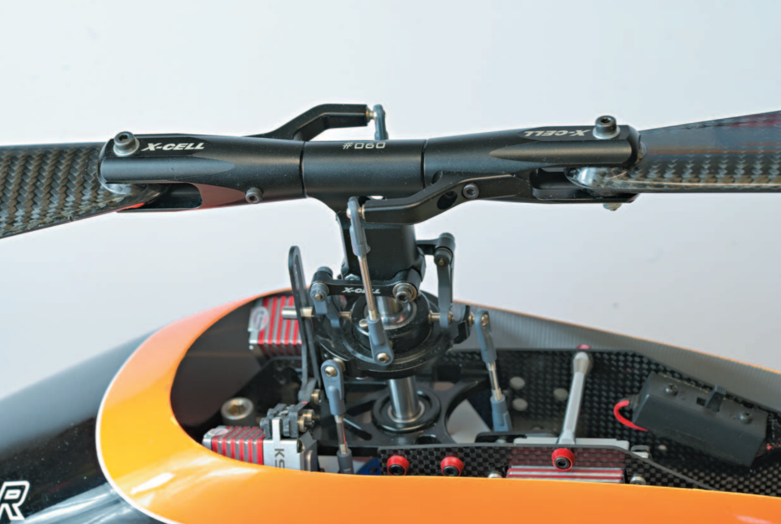
Der schwarz eloxierte Hauptrotorkopf des Interceptors mit optimierter Geometrie.
