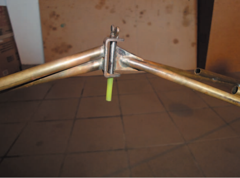
Ein einfaches Scharnier um die Hochachse sorgt für eine feste Verbindung zum Anhänger, der über eine verschraubte Deichsel angehängt ist.
