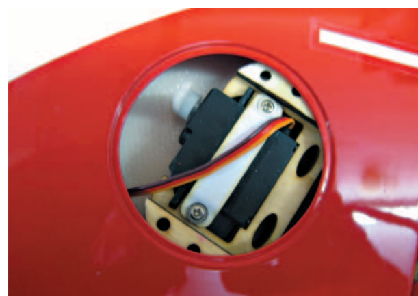
Das Servo zur Anlenkung des Höhenruders ist bereits werkseitig verbaut. Hier erspart man sich jede Menge Fummelei.
