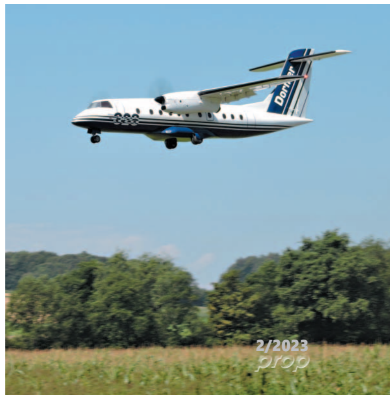
Karl Reisers Dornier Do 328 im Flug. Spannweite 3.800 mm, Gew. 24.500 g, Akku 2 x 12s, 7 Ah.
