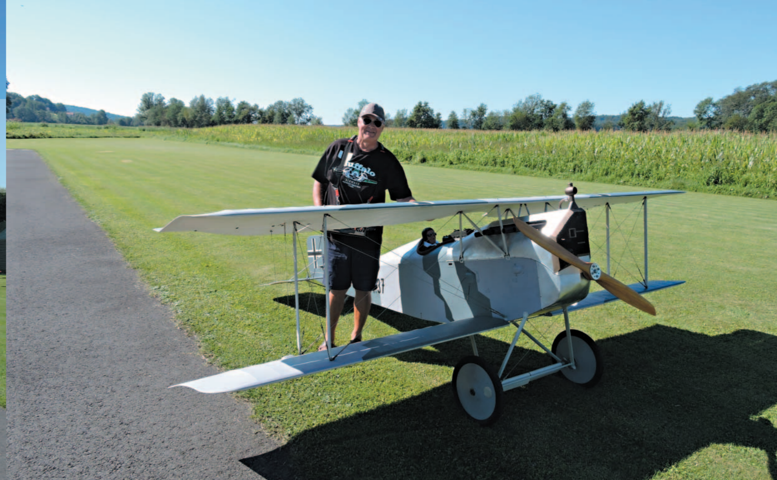
Das schwerste Flugzeug mit ca. 68.000 g heuer war die Aviatik Berg D I, gebaut und geflogen von Bernhard Klauscher. Spannweite 4.000 mm, Akku 15s, 30 Ah.
