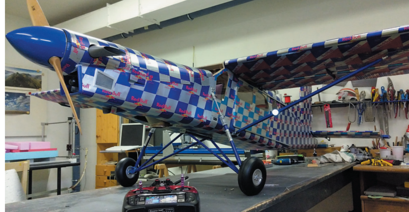
Bis auf die Verglasung der Kabine ist die PC-6 fertig gebaut. Das Gewicht der Blechbeplankung liegt bei 1.150 Gramm und ist für die Größe des Modells vertretbar.
