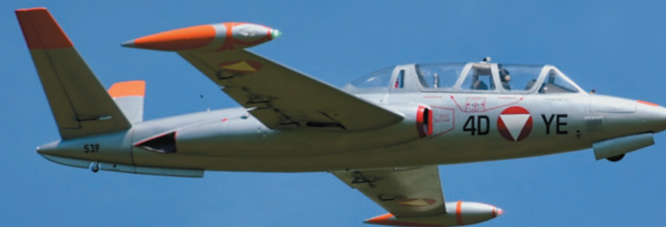
Bundessektionsleiter für Modellflug Peter Zarfl eröffnete das Retro-Meeting mit einer zweistrahligen, mit Impeller betriebenen Fouga Magister CM 170, scalemäßiger Ausbau ließ diese Maschine wie echt aussehen, Gew. 15.100 g, Spwte. 3.300 mm, Akku 2x 12s (Bild Rolf Konrader).
