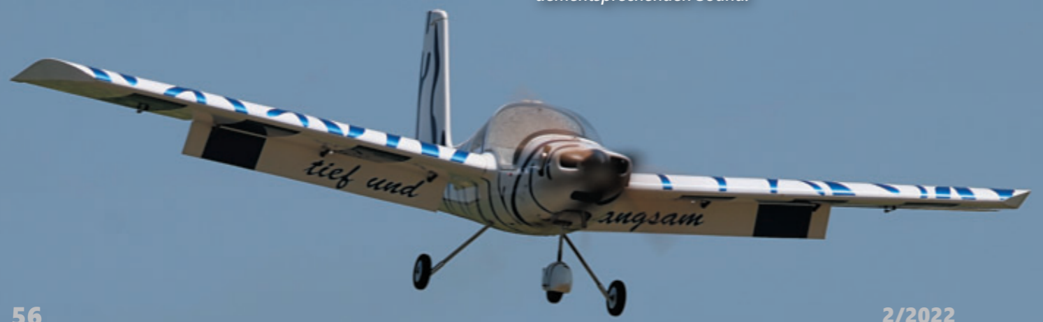
Eines der vielen braven Arbeitspferde dieses Seglertages, ein Swiss Trainer mit Valach 140 4-Takt Boxermotor und dementsprechenden Sound.
