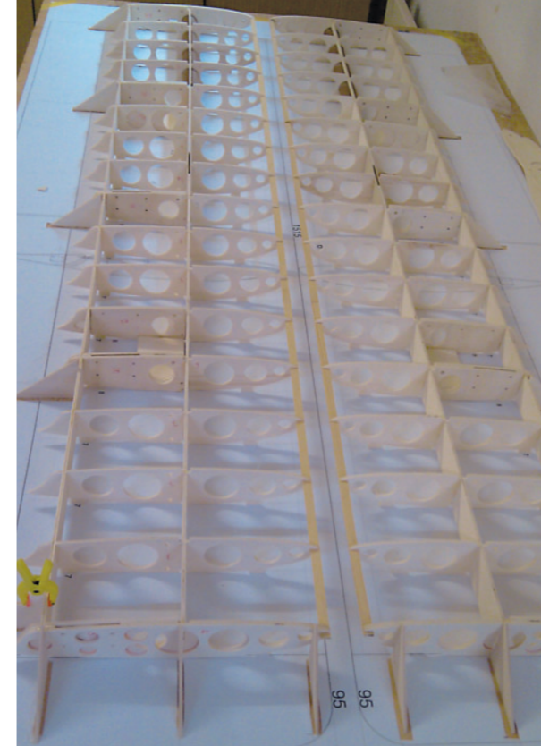
Der Aufbau der Tragflächen erfolgte in Rippenbauweise. Alle Teile sind CNC-gefräst und entsprechend paßgenau ausgeführt.
