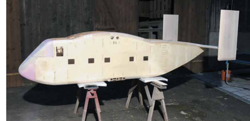
Der fertige Rumpf mit dem zweigeteilten Seitenleitwerk ist bereits verschliffen, gespachtelt und in Form gebracht.
