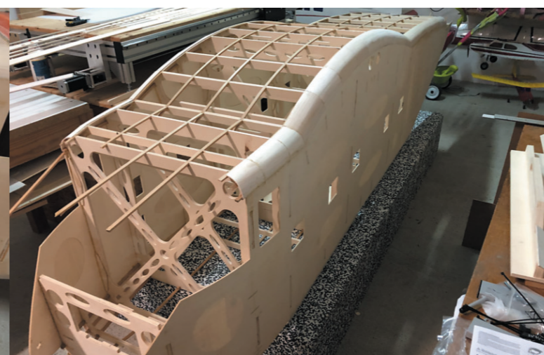
Zwischen den beiden Seitenwänden des Rumpfes entsteht mit Hilfe formgebender Spanten das Rumpfgerüst. Dieses wird anschließend beplankt, verschliffen und lackiert.
