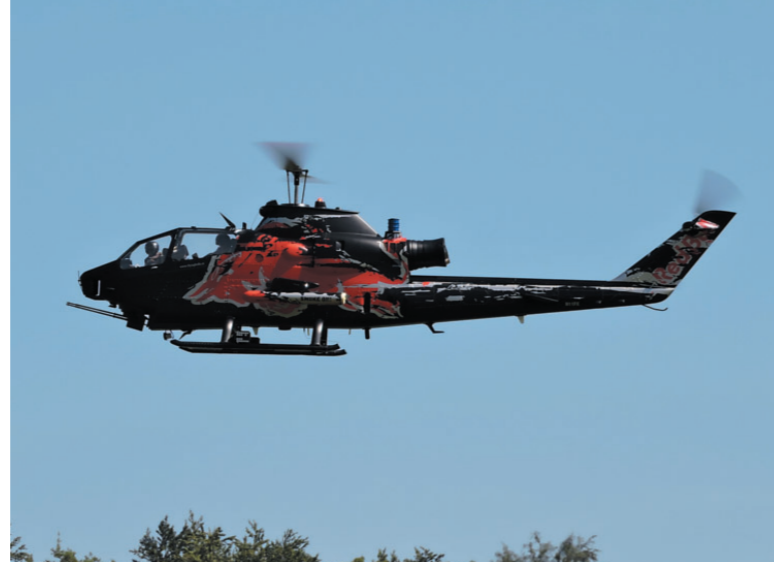
Sepp Schmirll präsentierte den riesigen, turbinengetriebenen Hubschrauber „Red Bull Bell Cobra AH1“, Gew. 38.000 g, Rotordurchmesser 3.350 mm.
