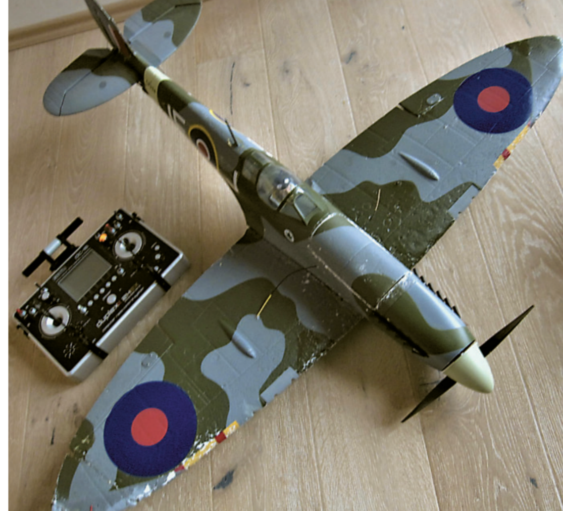
Als Testmodell für den EX 5 diente eine ältere ausrangierte 1.200 mm Schaum-Spitfire mit kritischen Flugeigenschaften.
