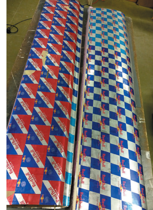
Die fertig beplankten Tragflächenhälften mit ca. 90 x 90 mm großen Blechblättchen. Diese Größe der Plättchen konnten aus einer Dose herausgeschnitten werden. 220 dieser Bleche waren für die beiden Tragflächenhälften notwendig!
