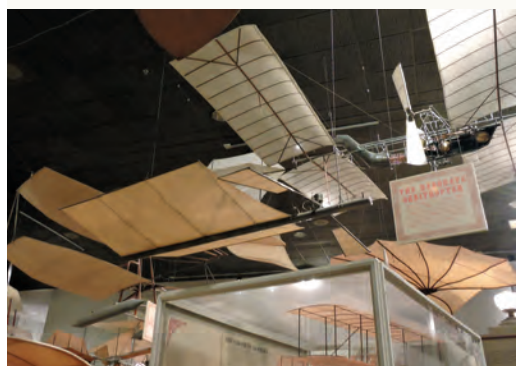
In Australien flog L. Hargrave (1850-1915) erfolgreich das im Vordergrund mit einer Dampfmaschine betriebene Modell. (NASM Washington DC)
