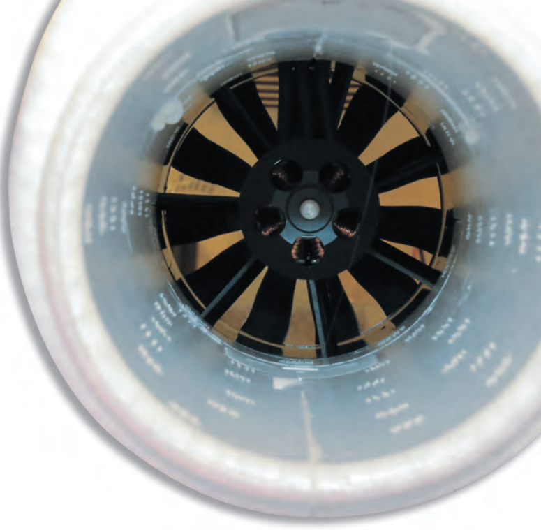
Mit einem 64 mm elfblättrigen Impeller, der von einem 4s, LiPo angetrieben wird, steht mehr als ausreichend Leistung zur Verfügung.
