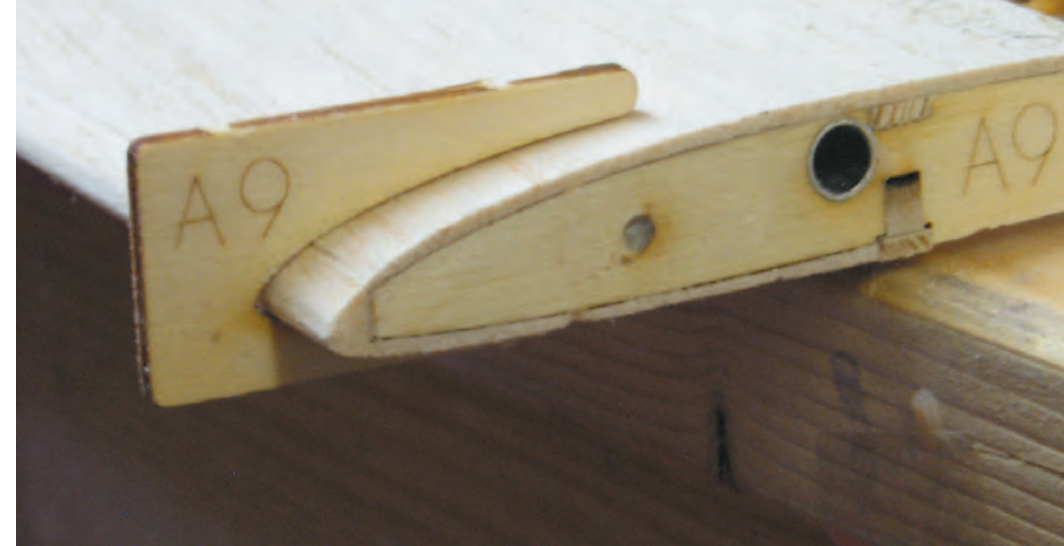
Das Verschleifen der Profilnasen ist ausschlaggebend für gute Flugleistungen. Mit insgesamt vierzehn Schablonen und genauer Positionsangabe der jeweiligen Schablonen am Flügel erzielt man mit etwas Mühe eine hervorragenden Tragfläche
