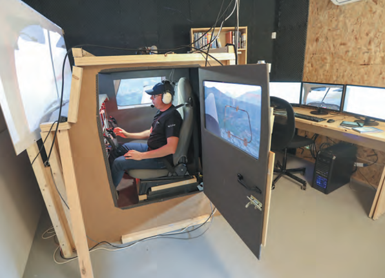
Der Flugsimulator steht im Hobbyraum von Markus Mittermüller und ist Marke Eigenbau. Auch das Cockpit und die Instrumente hat er selbst eingebaut und nach dem Vorbild der Mooney M20 gestaltet.
