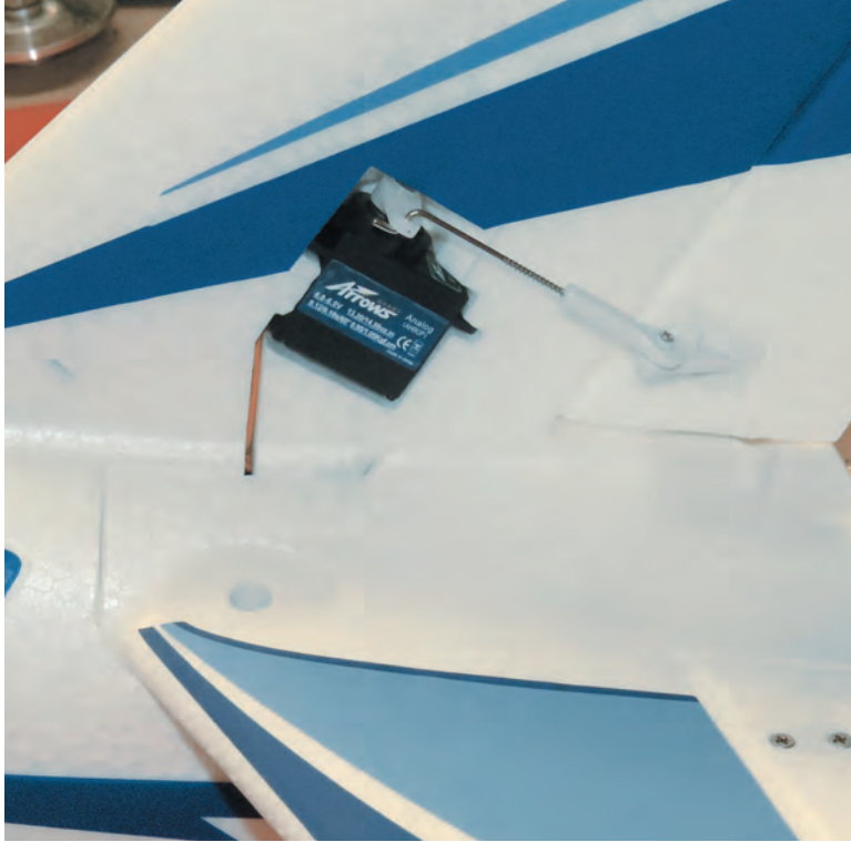
Acht neun Gramm Servos verrichten ihren Dienst in dem Modell des Marlin. Hier ist die Ansteuerung des Seitenruders zu sehen.
