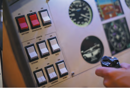
Als Schalter hat Markus handelsübliche Kippschalter verbaut, da die Originalschalter aus dem Luftfahrtbereich ein Vermögen kosten.
