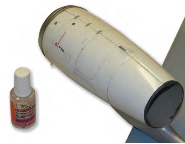
Für eine sehr gute Haftung und zum Auflösen der Trägerfolie wird ein spezieller Weichmacher verwendet.
