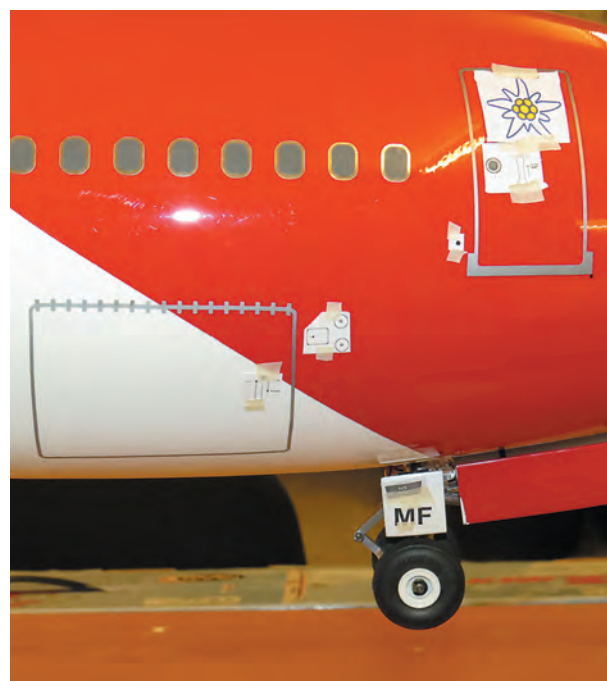
Die einzelnen Decals werden ausgeschnitten und probeweise an der vorgesehenen Stelle angebracht. Somit kann überprüft werden, ob die Größe passt, bzw. ob man keinen Schriftzug vergessen hat.
