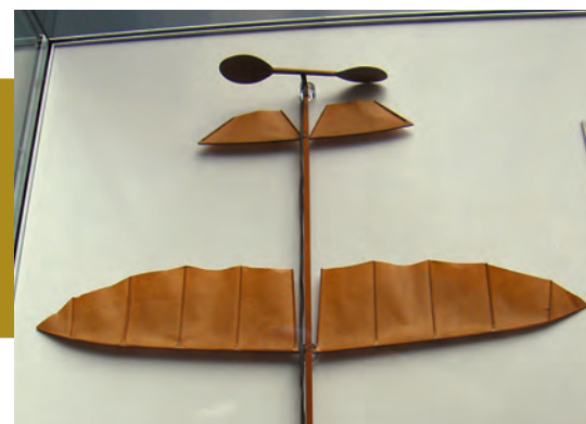
In Frankreich entwickelte Alphonse Pénaud (1850-1880) den verdrillten Gummimotor zum Antrieb von Modellen. (Verkehrshaus Luzern)
