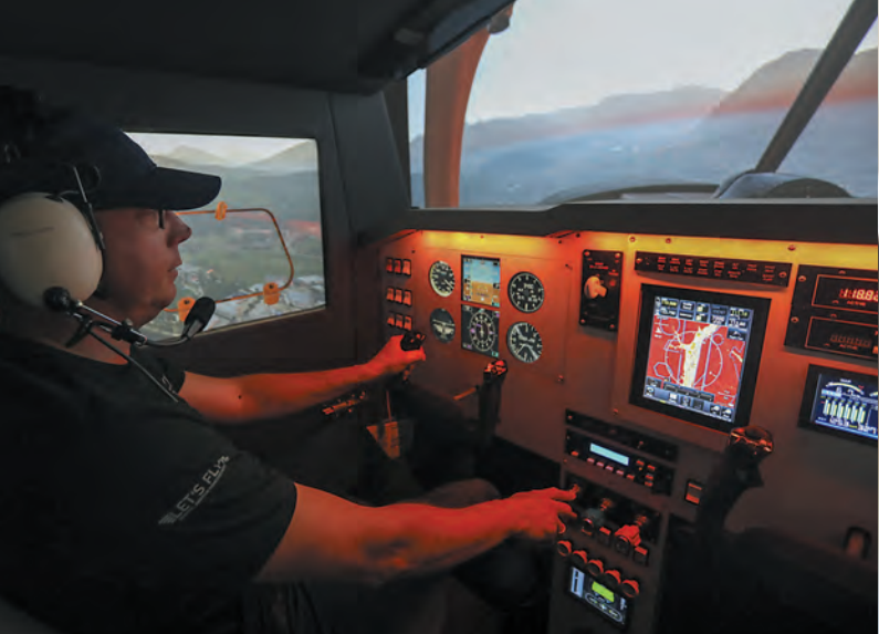
Ein Beamer und zwei 32 Zoll Bildschirme sorgen für einen guten Überblick im Flug und lassen echtes Flugfeeling aufkommen.
