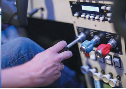
Die Schalter sind mit einem Minicomputer vom Typ „Arduino“ verbunden. Die originalen Schalter einer Mooney kosten rund 90 $ pro Stück. Daher hat Markus diese mit dem 3D Drucker ausgedruckt.
