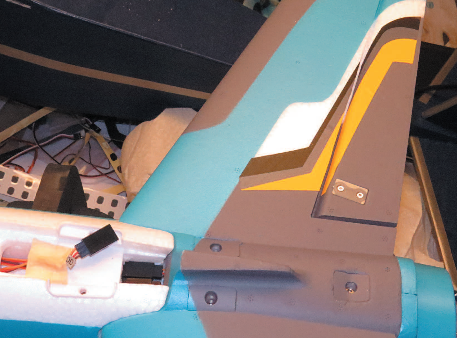
Befestigt wird das Höhenleitwerk am Rumpf mit Hilfe dreier drei Millimeter Schrauben.
