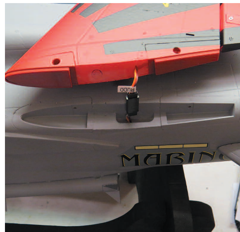
Die beiden Seitenleitwerkshälften sind am Rumpfrücken zu montieren und die Stecker der Servokabel zu verbinden. Die Sicherung erfolgt mittels zweier 3 x 16 mm Blechschrauben in den dafür vorgesehenen Sicken am Rumpf.
