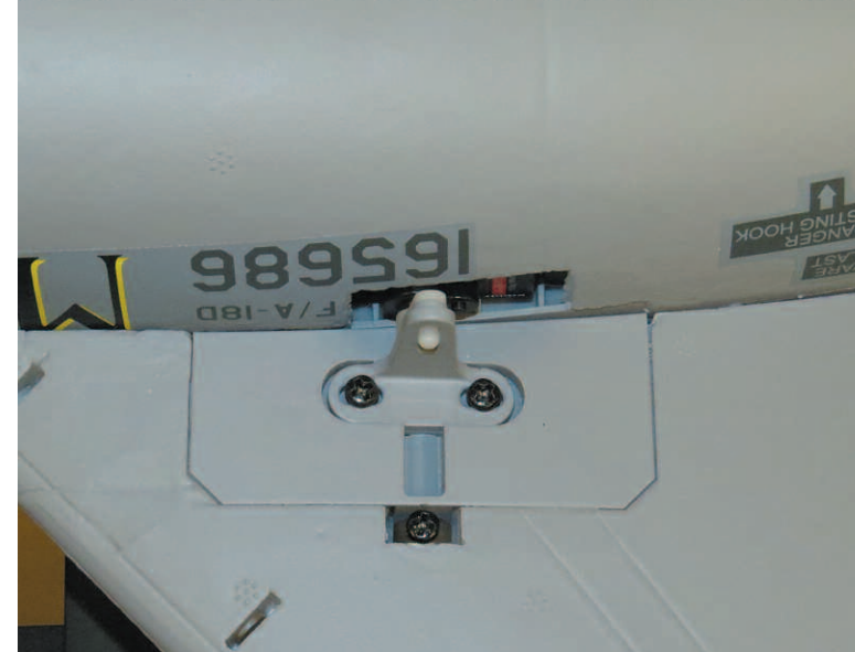
Das Höhenruder ist als Pendel ausgeführt und das Höhenruder-Steuerhorn wird mit Hilfe zweier 3 x 8 mm Schrauben auf der Unterseite des Stabilisators befestigt. Der Stellring ist in der Vertiefung am Stabilisator zu positionieren und auf die aus dem Rumpf herausragende Welle zu schieben. Die Fixierung der Höhenruderhälfte auf der Welle erfolgt mittels der Schraube des Stellrings.
