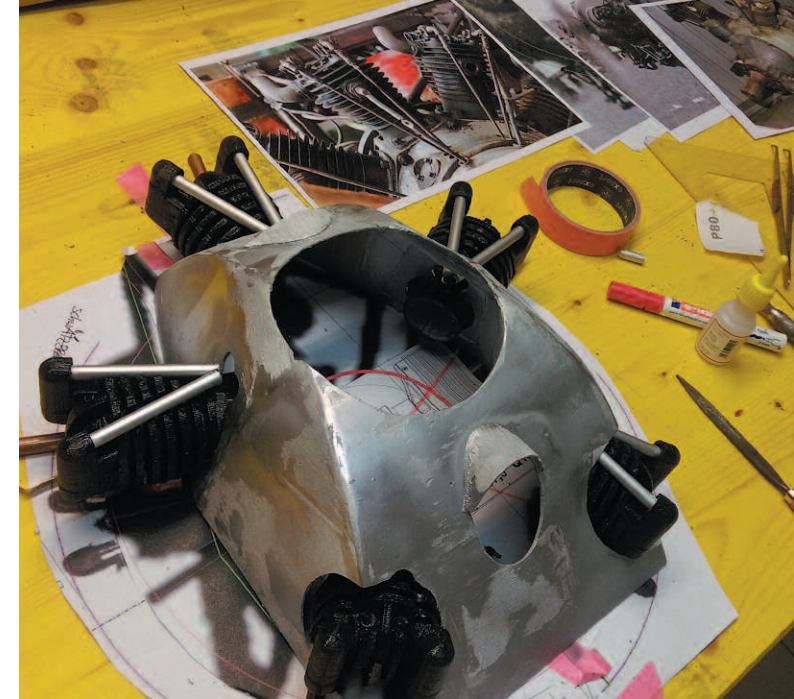
Die Motoratruppe ist detailgetreu nachgebildet und die Zylinder entstammen einem 3D-Drucker eines befreundeten Fliegerkollegen.
