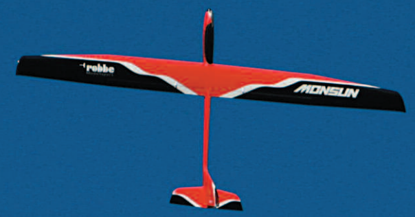
Mit einem Gewicht von rund 3.000 Gramm und dem Profil HQ/W-2,5/9 sind ausgedehnte Flüge sowie schnelle Abstiege mit Kunstflugeinlagen möglich.
