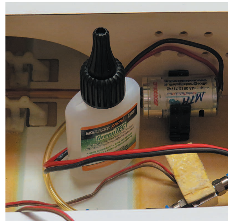
Zum Einsatz kam der Klebstoff beim Bau des Jetmodells Wild Hornet, wo diverse Einbauten, wie das Kero-Ventil oder das Montageblättchen aus Sperrholz, auf denen die JetTronic-Ventile montiert sind, eingeklebt wurden.
