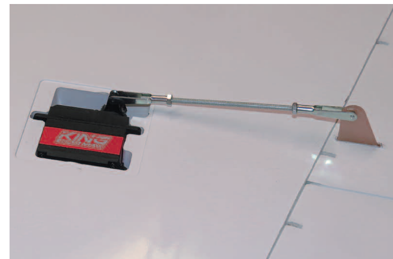
Das Servo KM5521MDHV kommt beim Modell „Wild Hornet“ in der Tragfläche für die Quer- und Höhenrunder Funktion zum Einsatz.
