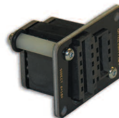
Über Distanzhalter wird die Bodenplatte mit der Blende verschraubt, dabei sollte man nicht auf die Gummitüllen zur Schwingungsdämpfung vergessen.
