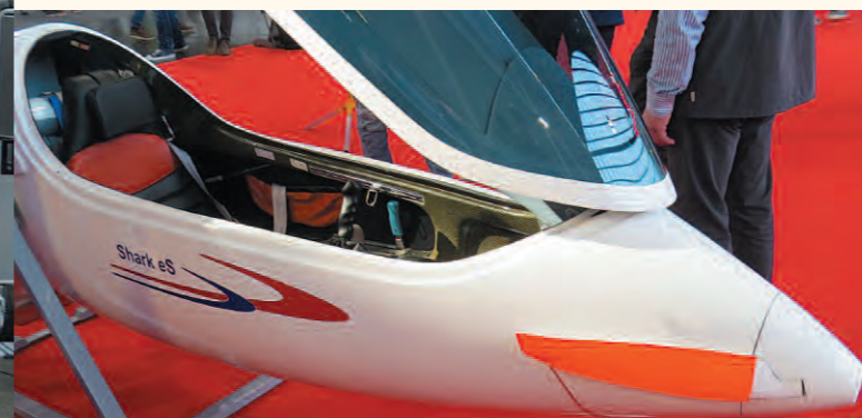
Das im Modellflug schon seit einigen Jahren verwendete FES-Antriebssystem hat man nun auch auf den manntragenden Bereich übertragen, wie hier beim Segelflugzeug Shark 304 ES zu sehen ist.
