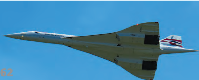
Eine der Concorde die aus einem Bausatz von Peter Michel/Michael Bräuer entstanden sind. Das 4.400 mm lange und 1.850 mm spannende Modell ist im Maßstab 1:14 hergestellt.
