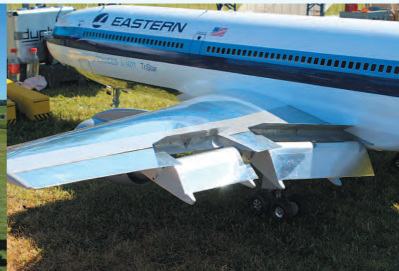
Beeindrucken konnte die Klappenmechanik von Dominik Eschers Lockheed 1011 Tristar, wo nicht nur die Landeklappen funktionsfähig sind, sondern auch die Spoiler und Vorflügel – einfach einzigartig!
