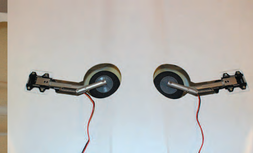
Für das Hauptfahrwerk waren die Ausschnitte bereits werkseitig vorhanden, sodass nur noch der Einbau beider Hauptfahrwerke erfolgen musste.
