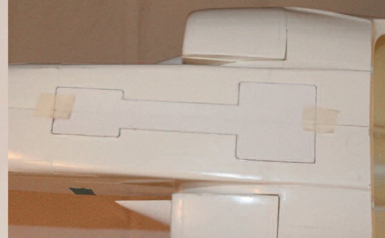
Vor dem Einbau der Bugfahrwerkshalterung in den Rumpf muss noch der Ausschnitt am Rumpfboden erfolgen. Die dafür passende Schablone befindet sich auf der Bauanleitung-CD.
