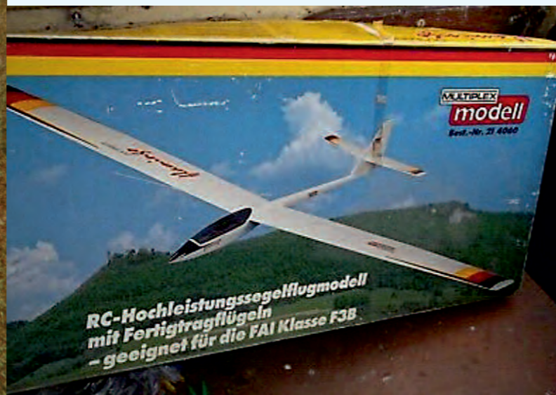
Mit dem von uns zum Seglerschleppen gewählten Flamingo hatten wir allerdings keinen Volltreffer gelandet. Zwar lag das Gewicht nur bei 2.200 Gramm, aber das eingesetzte Tragflügelprofil waren völlig konträr zum Big Lift und ergab deshalb kein harmonisches Gespann!
