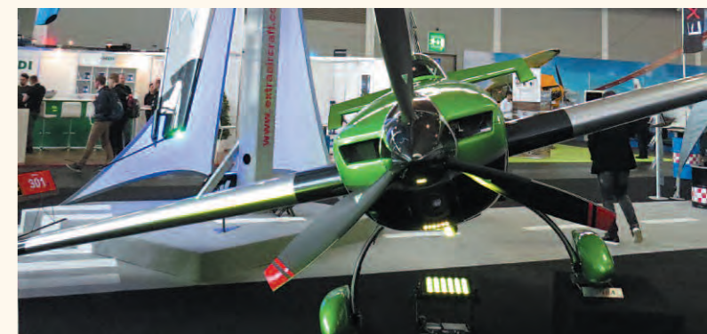
Die Extra 330 SC ist mit einer Kohlefaser-Tragfläche und darin integriertem Tank ausgestattet. Der Lycoming AEIO-580 B1A verleiht dem Flugzeug eine Leistung von 315 PS.
