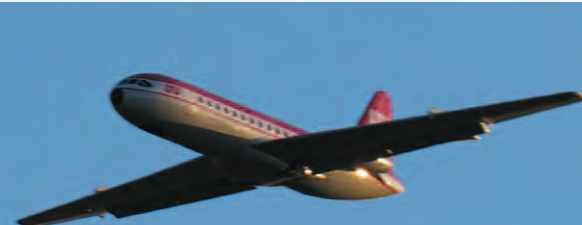
Norbert Rauch hat neben seinen Airlinermodellen mit Kerosintrieb auch diese Sud Aviation Caravelle mit im Gepäck. Das 2.400 mm spannende Modell mit einer Länge von 2.000 mm wird von zwei 69 mm WeMoTec-Impeller Mini Fan evo angetrieben.
