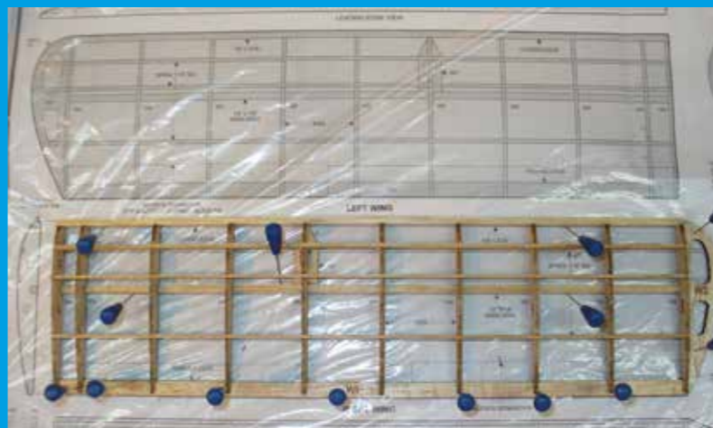
Die im Rohbau aufgebaute rechte Tragflächenhälfte beim Trocknen. Als Klebstoff kam hier Holzleim zum Einsatz.
