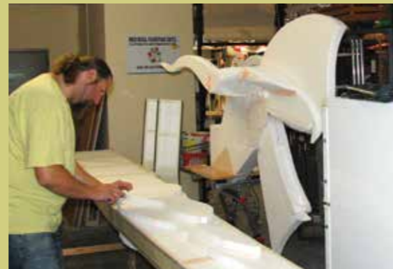
Die Rumpfverschönerung wird angebracht, ausgebildet aus 3 cm Styroporplatten.
