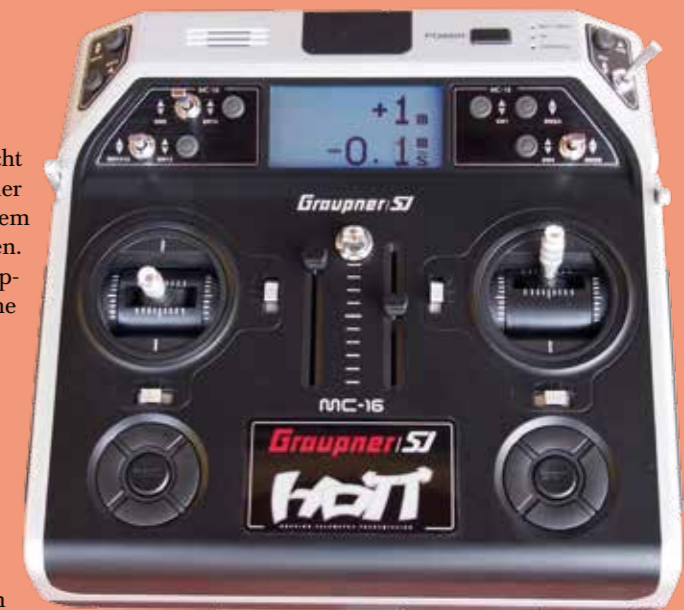
MC-16 HoTT nach Einbau der beiden Schalter
