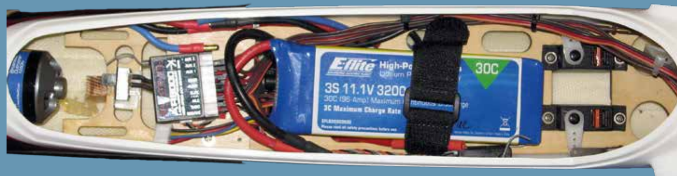
Ausreichend Platz im Cockpit. Der Regler ist unter dem Akku platziert.
