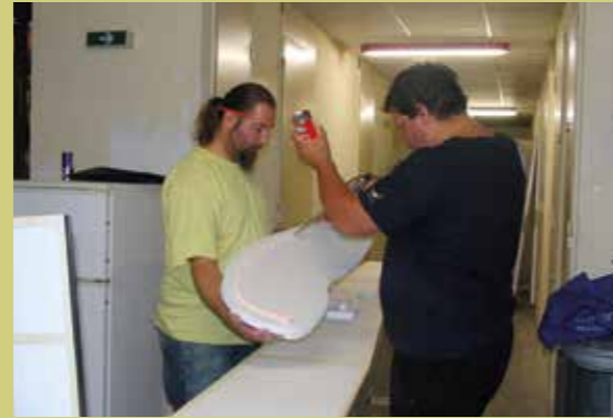
Fast alles wurde mit PU-Schaum verklebt, um Gewicht zu sparen.
