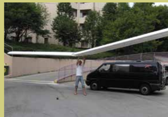
Die fertige Tragfläche, knapp 13 kg lassen sich leicht heben, Wind sollte allerdings keiner gehen.
