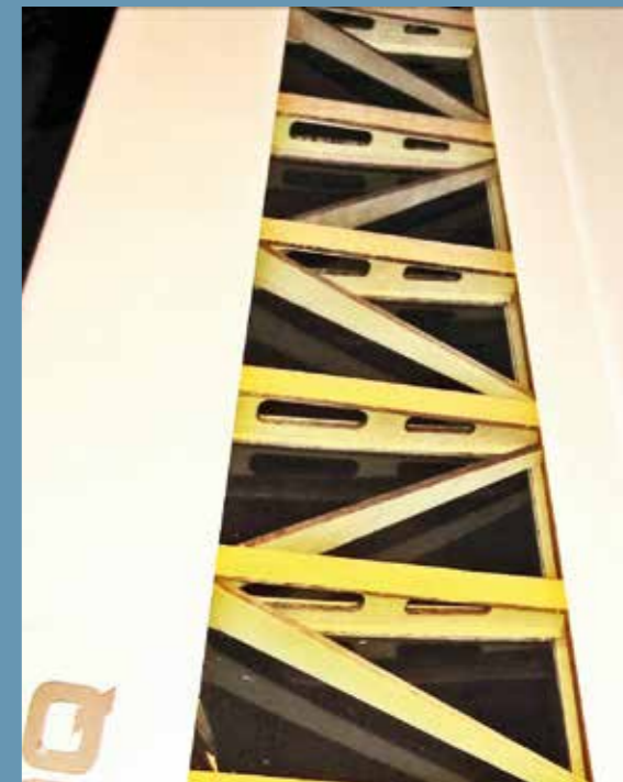
Geodätische Bauweise des Flügels der MYSTIQUE
