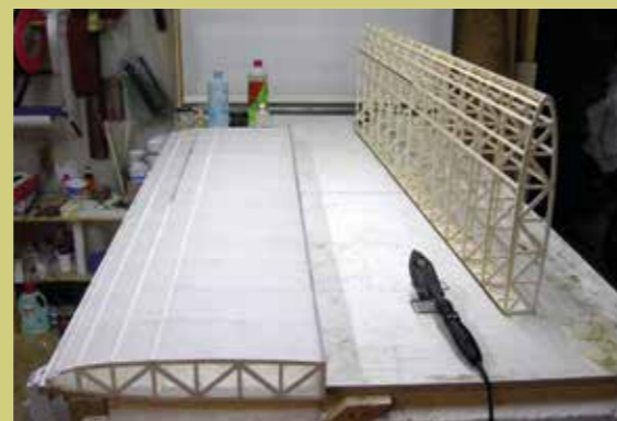
Die beiden Leitwerke, gut zu sehen sind Haupt- und Stützholm am stehenden Teil.
