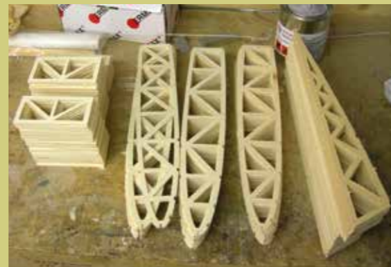
Der gesamte Rippensatz, 7 Stunden war die Fräse im Einsatz.
