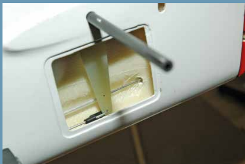
Bereits fertig eingebaut der GFK-Pendelhebel.
