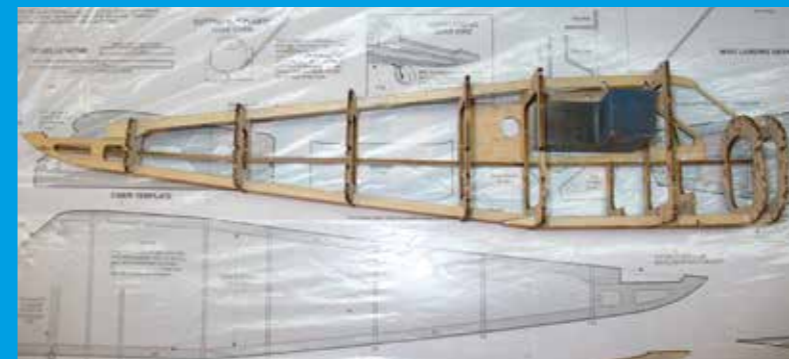
Der Aufbau des Rumpfes erfolgt direkt am Plan in Halbspanten-Bauweise
