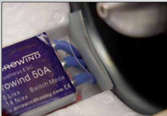
Der Regler sitzt gut gekühlt und ebenfalls passgenau vor dem Triebwerk. Die Kabel werden mit einem Stück Kraftstoffschlauch vor Abrieb geschützt
