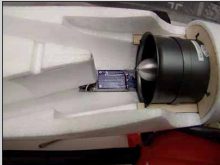
Vorbildliche Luftführung und hohe Passgenauigkeit zeichnen die Viper aus
