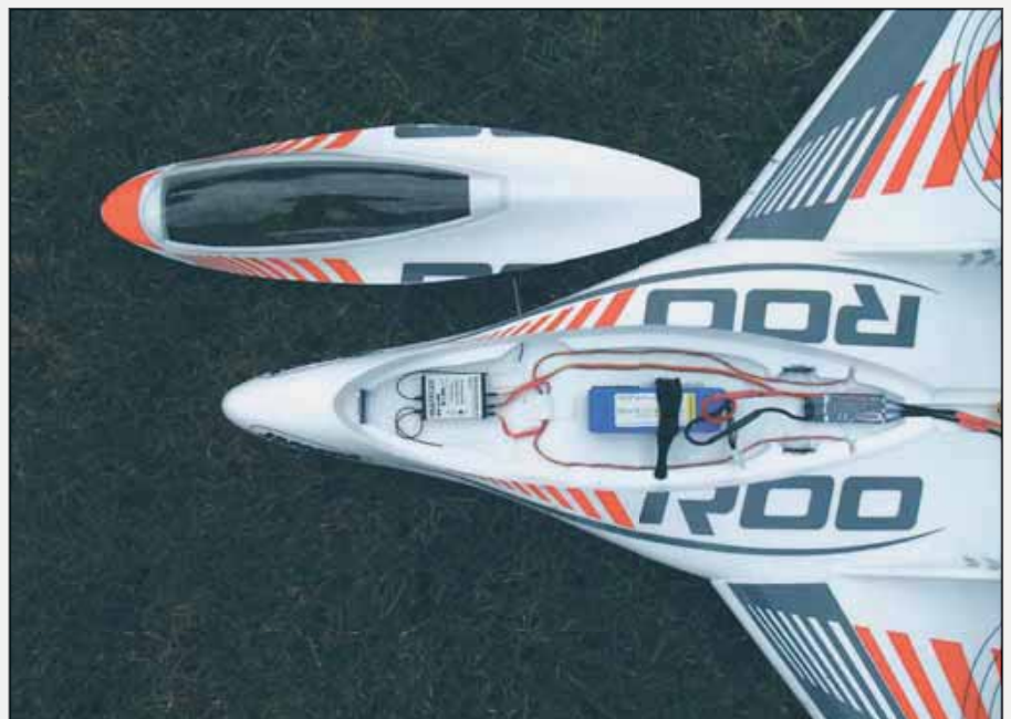
Viel Platz unter dem Deckel. Ideal für den Einbau einer Kleinturbine
