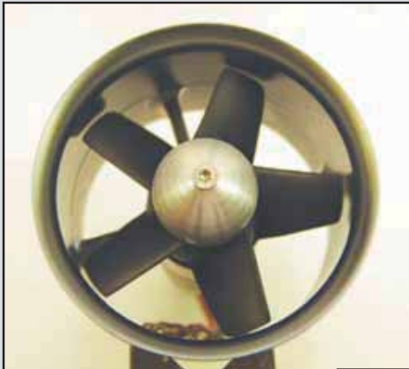
Das Lander 68 mm Triebwerk mit Arrowind 50 A Regler
