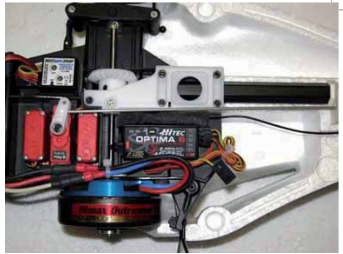
Der 12-polige Brushless-Außenläufer sitzt direkt unter der Hauptrotorwelle und treibt den Hauptrotor direkt an.
