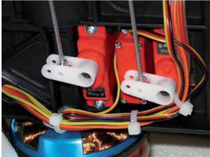
Bei wirklich hartem Flugbetrieb sollte man Servos mit Metallgetriebe verwenden.
