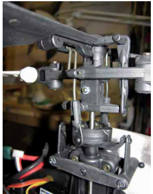
Der Rotorkopf, sauber aufgebaut und fast unzerstörbar.....
