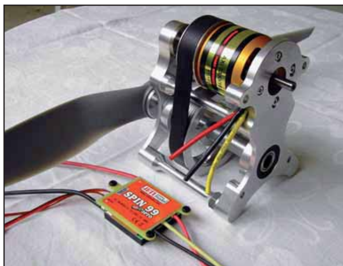
Eigenbautriebwerk von Josef und Michael Bader (MFC-Lienz) – hier als Variante mit einem AXI 5330/18
