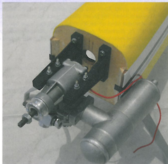
Der Motor ist hängend eingebaut und verschwindet dann fast zur Gänze unter der Haube
