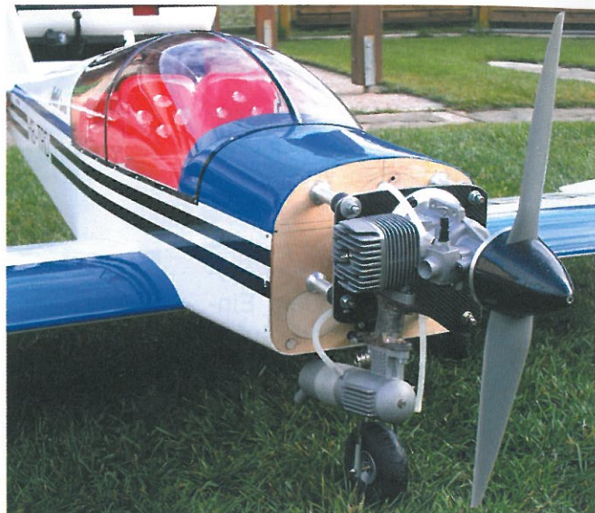
Power-Triebwerk: Magnum 180 AR, montiert auf Kohlefaserplatte, Aluminiumabstandhalter und Schwinggummis. Gut erkennbar das Auspuffdistanzstück.
