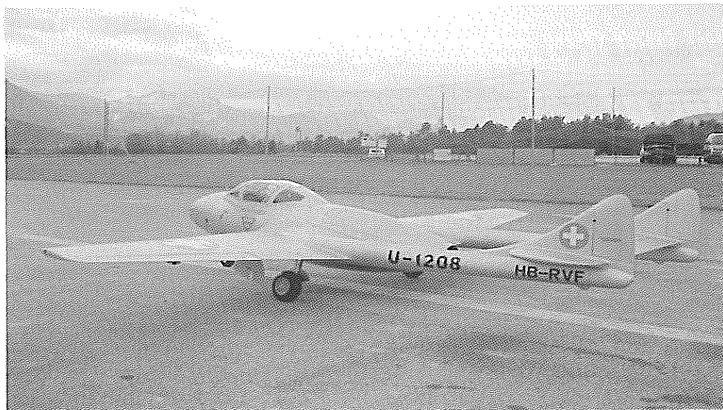
Modell: De Havilland DH 115 „Vampire“ T55 Maßstab: 1:6; Spannweite: 1932mm; Länge: 1752mm; Startgewicht: 8700g gebaut und geflogen von Manfred Eberhard
