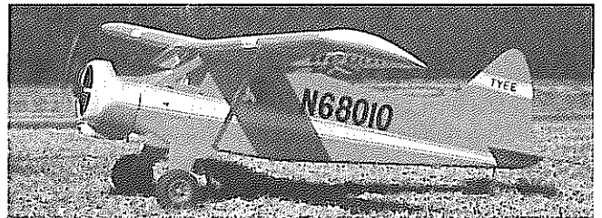
De Havilland Beaver Spannweite 2438 mm, Gewicht 5 kg, Flügelfläche 63 dm 2 , Motorisierung ab 20 ccm 2T oder 4T, mit Schwimmern ab 30 ccm
