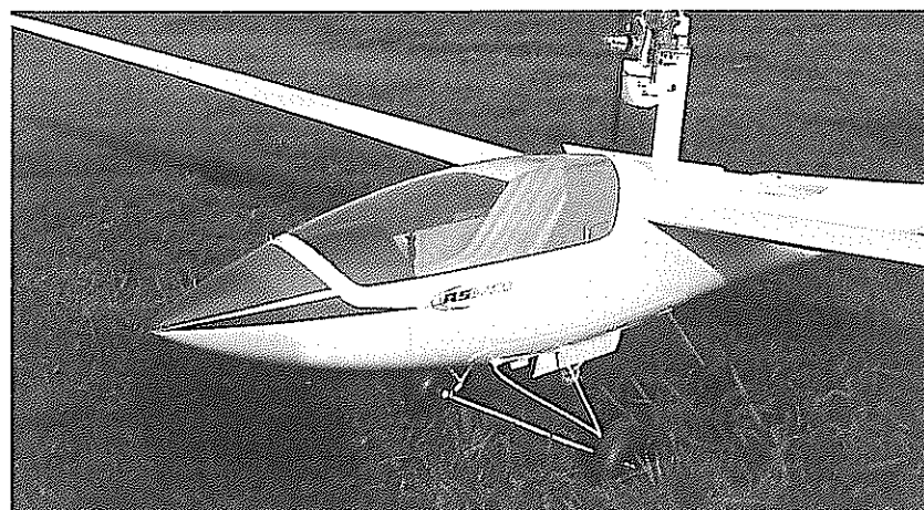
Ein echtes Klapptriebwerk, ganz wie beim großen Vorbild. Nach Abschalten des Motors verschwindet alles im Rumpf, die Klappen schließen sich. Für den Start von der Piste weg sorgt ein Fahrgestell, das nach Abheben des Modells abgeworfen wird.
