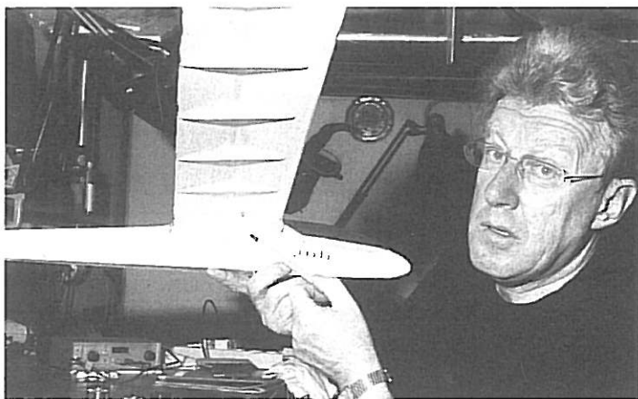
Die richtige Lage des Schwerpunktes ist für jedes Modell von eminenter Wichtigkeit. Mitunter müssen auf Grund der ersten Starts kleine Korrekturen durch Bleiballast vorgenommen werden. Auf dem Foto gut zu erkennen: die offene Bauweise des Jedelsky-Flügels.
