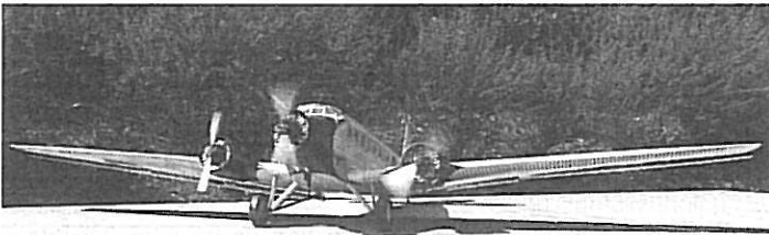
Die berühmte "Tante Ju 52", das Verkehrsflugzeug der 30er Jahre brauchte für ihre sagenhafte Stabilität ebenfalls eine nicht zu übersehende V-Form der Tragflächen.
