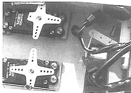
Der RC-Einbau. Die beiden Servos für Höhen- und Seitenrudder. Vorne dann das Servo für die Betätigung der Schleppkupplung. Die einzig richtige Lösung ist hier die Verwendung eines ausklinkbaren Hochstarthakens.
