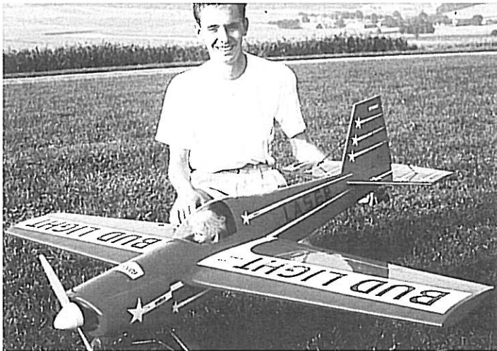
Kraftpaket Bud Light mit Webra 120-Motor. Trotz Zweitakter sehr leise und dennoch kraftvoll. Kein häßliche Hervorlugen von Motorteilen, alles verschwindet unter der Motorhaube.
