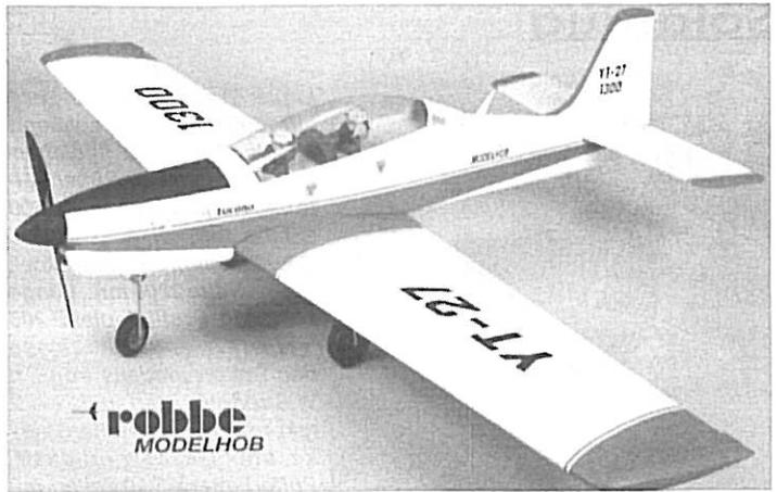
**Robbe Tucano, vorbildähnliches Kunstflugmodell für 6,5 ccm-Motoren. Entwickelt für Piloten mit einschlägiger Querruder-Erfahrung. Balsaholz-Rumpf, Balsabeplante Styroporflügel, tiefgezogene Motorhaube, vorgebogenes Dreibein-Fahrwerk, hoher Fertigungsgrad.**
