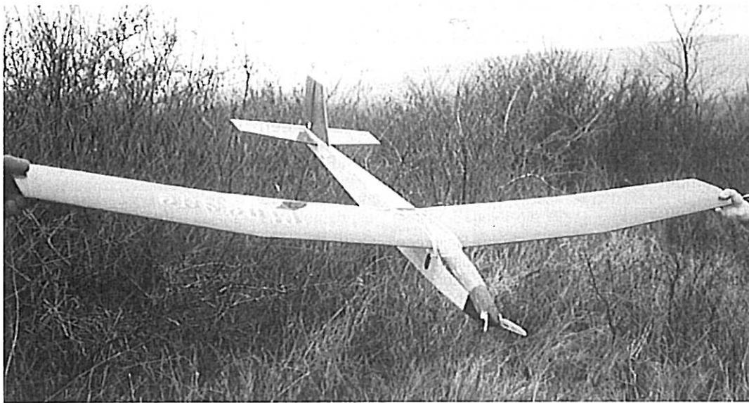
erwarten, der das Modell auch bei absoluter Windstille rasch auf Höhe bringt. In 25 bis 50 Sekunden wird eine Höhe von wenigstens 150 m und mehr erreicht. Mit dem Flugakku wiegt die flugfertige Finesse 1,4 kg, das sind bei einer Flügelfläche von 35 qdm 40 g/qdm, oder die Fläche des Höhenruders hinzuge-rechnet 35,5 g/qdm.
