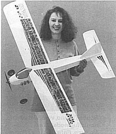
Links: Graupners Solar-Taxi, ein 1500 mm-Solarsegler mit 6- oder 7-zelliger Speicherbatterie, Steuerung über Seite und Höhe. Motor Speed 600 BB 8,4 Volt.
