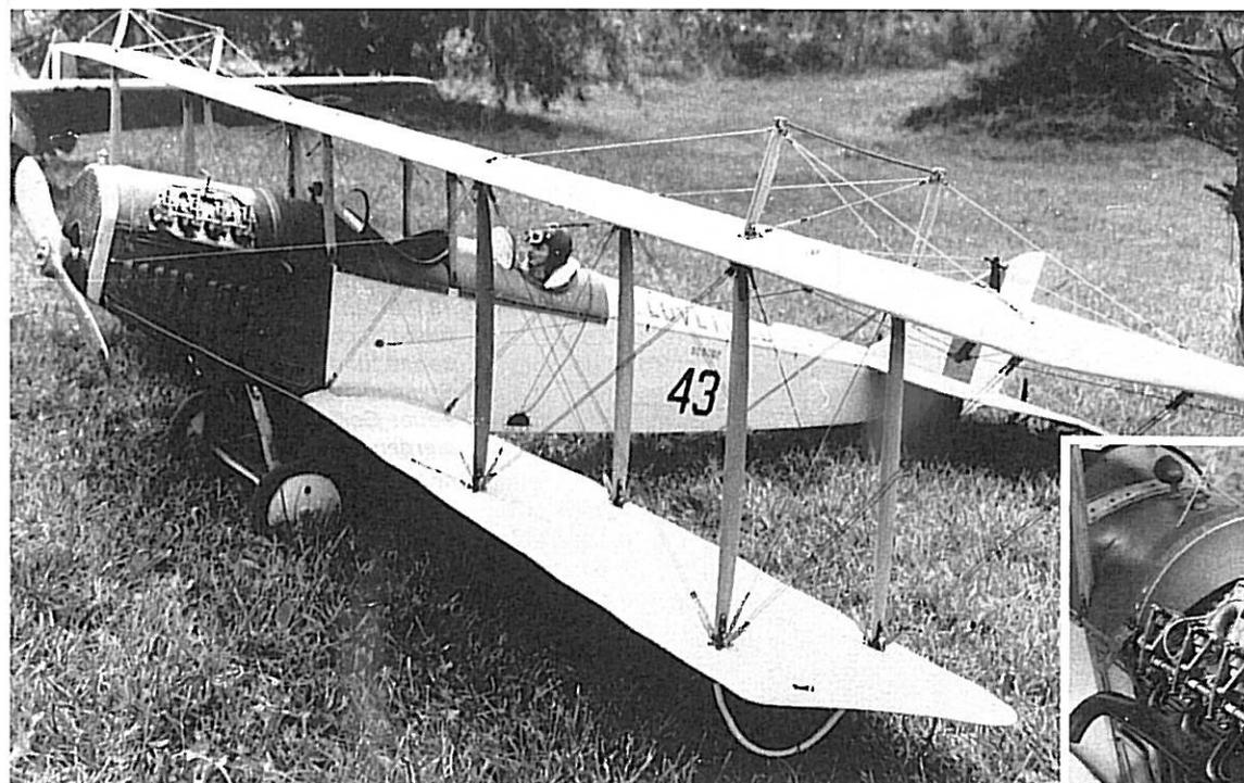
Ein sehenswertes Scale-Modell, eine Curtiss Jenny JN4-D2 der Jahre 1917/18, gebaut von dem Deutschen Max Geppert. Das bis ins letzte Detail vorbildgetreue Modell hat eine Spannweite von 1,78 m, wiegt 5,3 kg und ist mit einem 13 ccm Laeser-Motor bestückt.
