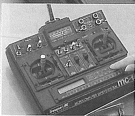
MC-18 ECO ausgebaut zur Expertenanlage
