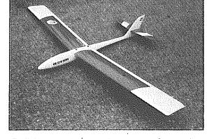
die Flächen: Nasen-, Endleisten und Randbogen werden angeleimt und verschliffen. Anschließend werden die Flächenhälften in der Mitte zusammengeharzt und die Klebestelle mit einem Glasgewebeband verstärkt. Die Querruder-Flaps
